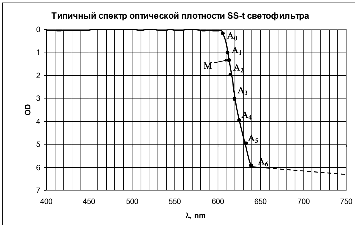
Рис. 2. Типичный спектр оптической плотности OD от \lambda . В точке A_0 OD=0.3 и T=50\% . Показаны также точки A_1, A_2 и т.д., отвечающие целым значениям оптической плотности. В стоп зоне T_{\text{min}} \leq 0,0001\% .
